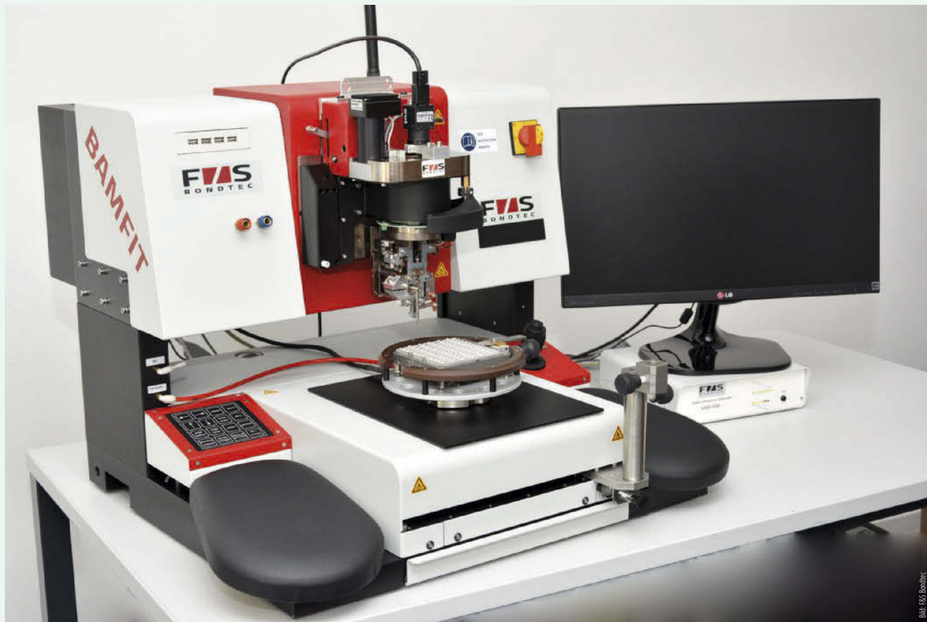
Das BAMFIT-Verfahren für die Drahtbonderfamilie 56XX einsatztauglich adaptiert: Dabei wird der Bondkopf einfach gegen den BAMFIT-Testkopf ausgetauscht.
