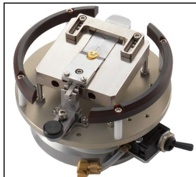
TO Aufnahme mit mechanischer Klemmung
